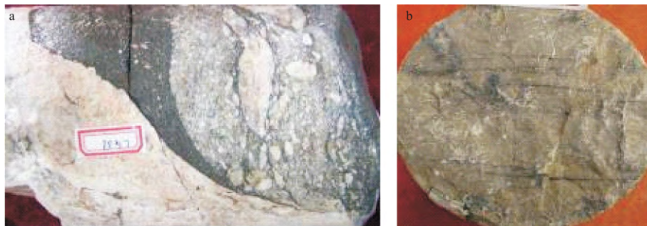
a. 良里塔格组溶洞充填砾屑、砂屑(6 219.22 m 井段); b. 良里塔格组裂缝被黑色沥青充填(6 214.52 m 井段)
